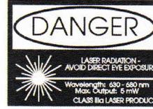
Cet instrument produit un rayon laser du côté arrière. NE JAMAIS TOURNER LE LASER VERS QUELQU'UN. VÉRIFIER TOUJOURS l'autre côté du verre en cours d'inspection pour s'assurer que personne ne regarde directement vers le laser.
